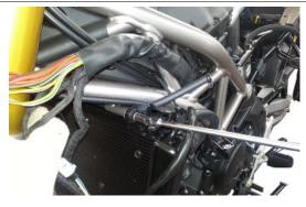
• Undo and remove the stud bolt.
